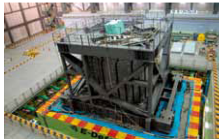
写真2 大型振動台を用いた杭・地盤破壊実験
