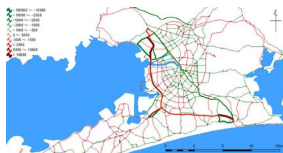
シミュレーションによる豊橋周辺道路の交通量変化予測(赤:増加, 緑:減少)
