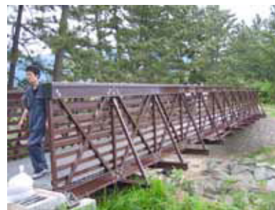
FRP歩道橋の加振による構造性能確認実験
