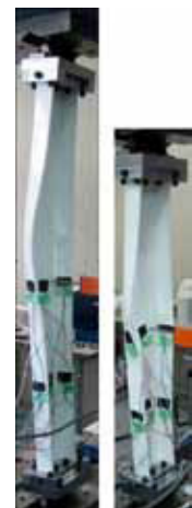
GFRP材の圧縮試験
