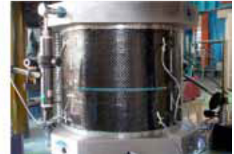
複合材料円筒シェルの圧縮試験
