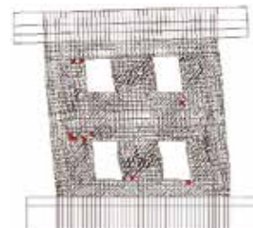
ひび割れ状況(解析)
