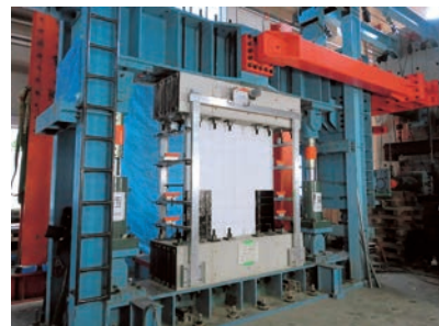
靱性型耐震補強壁の構造実験
