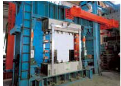
靱性型耐震補強壁の構造実験
